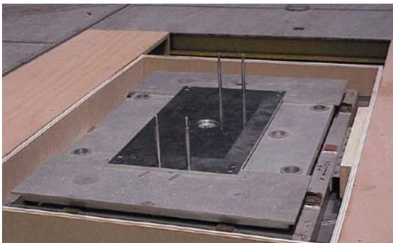
Balance dynamométrique insérée sous le plancher de la veine de la soufflerie et bras verticaux de liaison avec les maquettes
