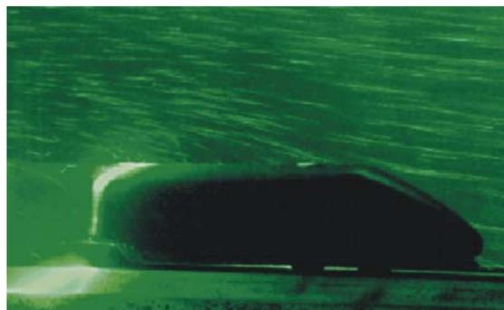
Visualisation de l'écoulement de particule par vélocimétrie laser
