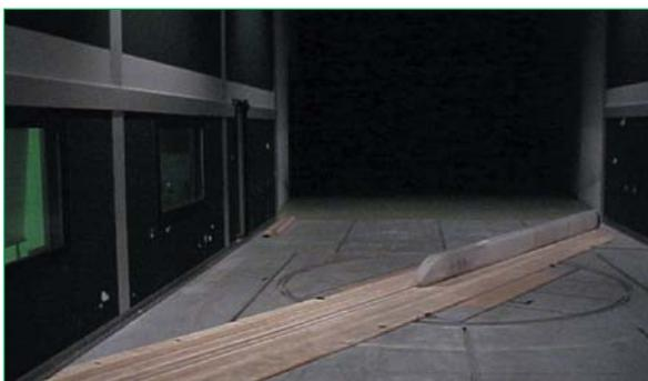
**Figure 8 :** Maquette TGV sur la table tournante de la veine haute vitesse de la Soufflerie Jules Verne (CSTB de Nantes)
